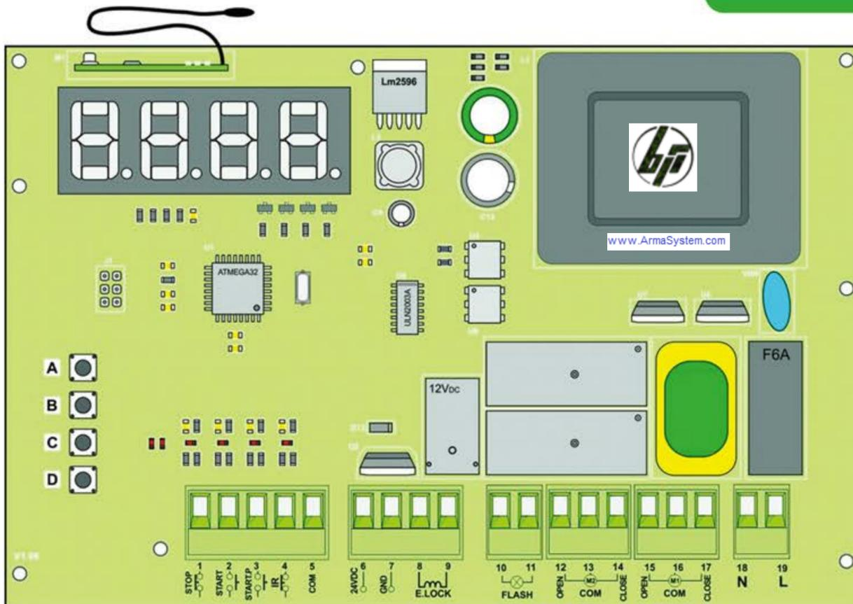
1-1. ترمینال های ورودی و خروجی مدار کنترل
