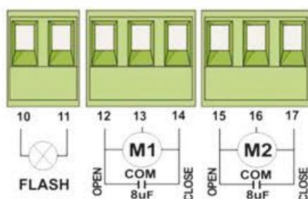
ترمینال 10 و 11 برای نصب فلاشر در نظر گرفته شده است. این فلاشر جهت ایمنی بیشتر و اعلام هشدار، در هنگام باز و بسته شدن درب عمل خواهد کرد. با توجه به منوی bLin می‌توان خروجی این ترمینال را تنظیم کرد. در صورتی که bLin، در حالت YES باشد مدار فلاشر روی برد فعال شده و کافی است به خروجی ترمینال یک لامپ 220 ولت متصل نمایید.
