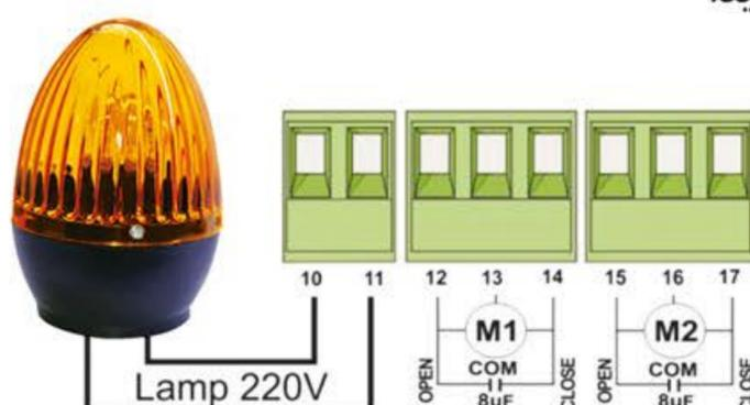
در صورتی که bLin، در حالت no باشد خروجی فلاشر ولتاژ 220 ولت ثابت خواهد شد.
