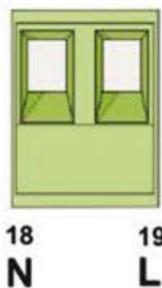
برق شهری (220VAC-50Hz) را به ترمینال‌های L و N برد کنترل متصل نمایید. پیشنهاد می‌شود یک فیوز مینیاتوری قبل از ولتاژ ورودی به برد کنترل تعبیه نمایید.
