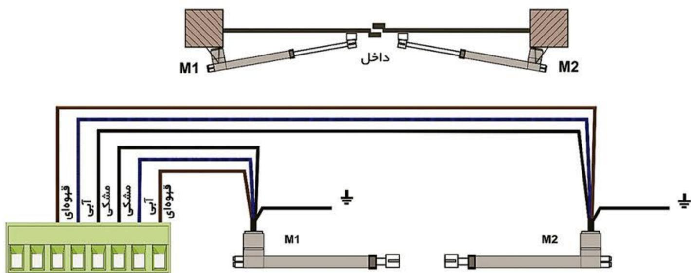
در کورس باز شدن، ابتدا موتور یک (M1) شروع به باز شدن کرده و پس از گذشت تأخیر تعیین شده توسط پارامتر  $t.dop$ ، موتور دو (M2) شروع به باز شدن می کند.
