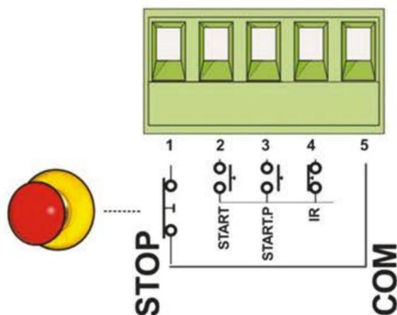
اگر در مدت‌زمان شمارش معکوس بسته شدن درب این شستی فشرده شود، بسته شدن اتوماتیک درب غیرفعال شده و درب در حالت توقف قرار می‌گیرد. برای بسته شدن درب باید با ریموت به سیستم، فرمان بسته شدن اعمال شود.
